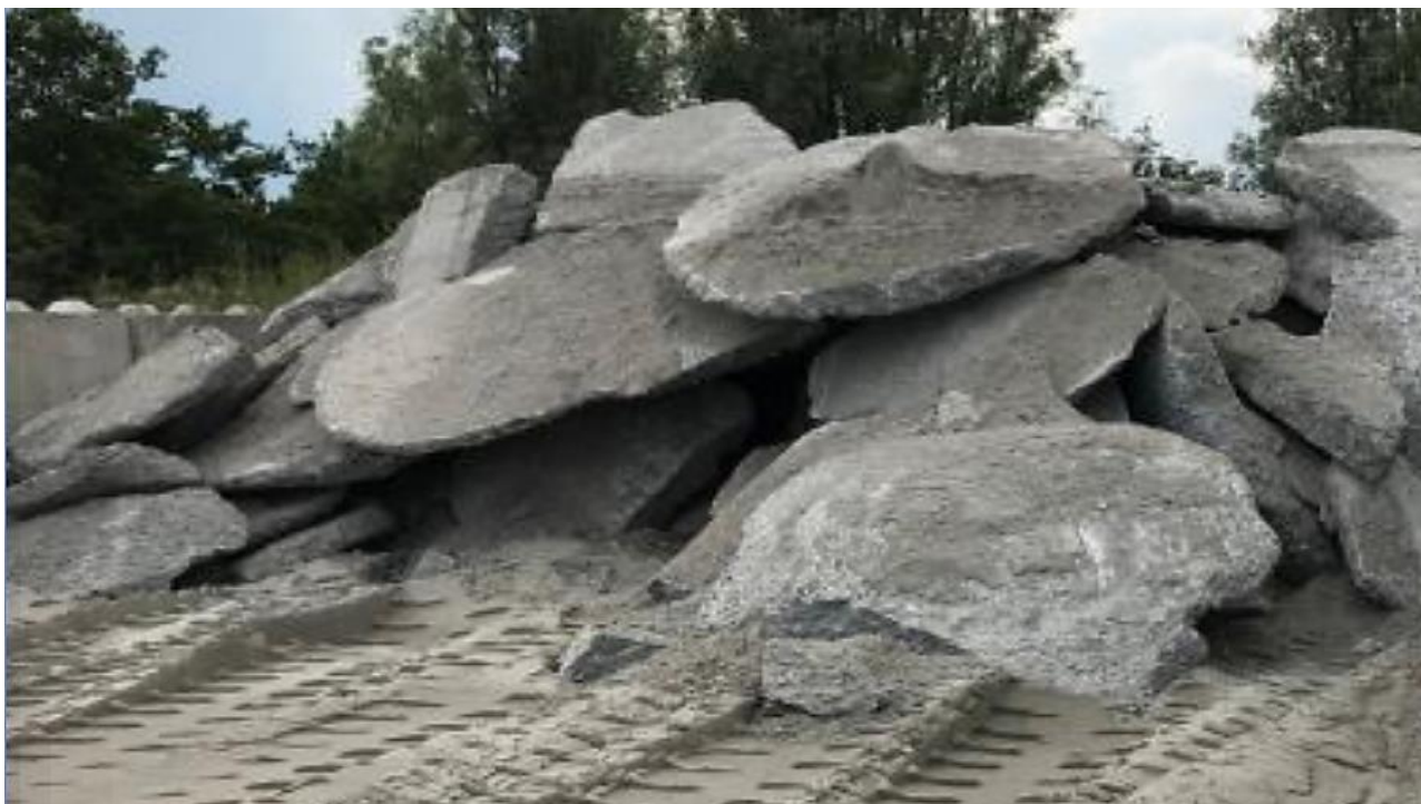
Figur 7: Lagringsplads for hærdnet spildbeton inden knusning. Betonen er læsset fra betonkanonerne på jorden til hærdning og efterfølgende lagt i en lagerbunke indtil nedknusning.
