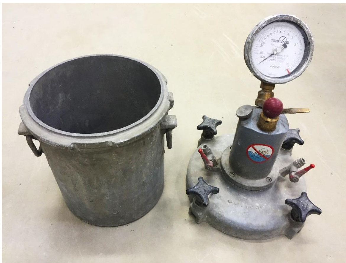
Figur 1. Pressuremeter til måling af luftindhold i frisk beton. Betonen kompakteres i beholderen, låget sættes på, og en detaljeret måleprocedure gennemføres. Herefter kan luftindholdet i betonen aflæses på måleuret.
