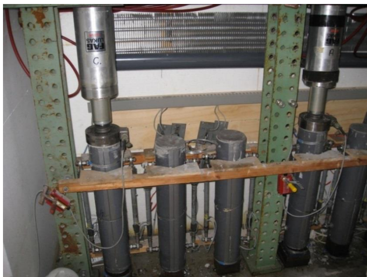
Figur 9. Opstilling til måling af autogent svind og krybning efter TI-B 102. Der måles autogent svind på tre emner og krybning på tre emner. Der måles fra betonens afbindingstidspunkt. Betonen udstøbes i plastrør, som sikrer, at der ikke kan udveksles vand med omgivelserne.
