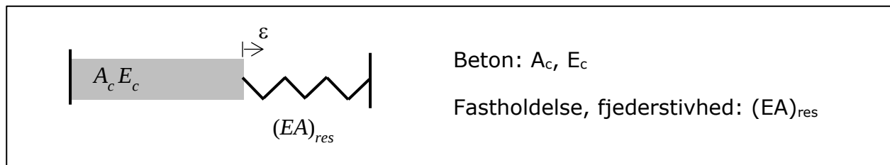
Figur 3. Betonemne udsat for endimensionel deformation pga. opvarmning og afkøling.
