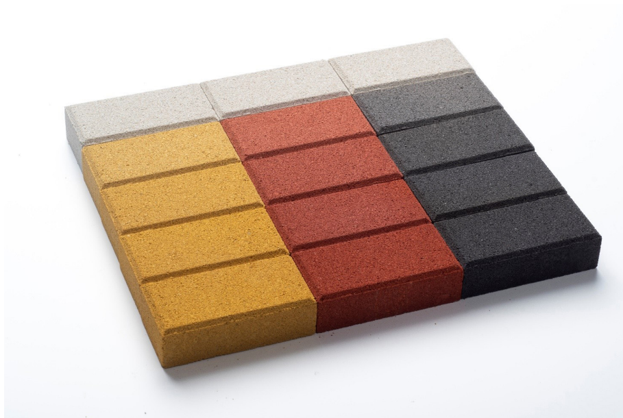
Figur 8 Farveintensitetens afhængighed af doseringsmængden (0, 2, 4, 6, 8 vægt-%. Foto: LANXESS Deutschland GmbH).
