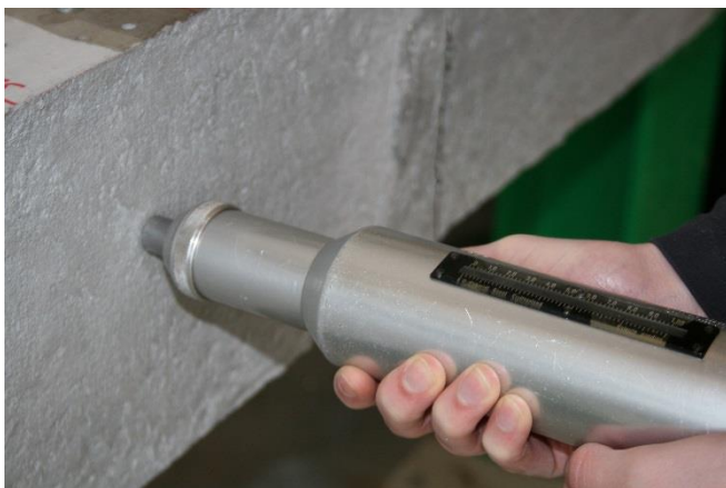
Figur 13. Schmidt-hammeren er et lille handy instrument til bestemmelse af betons styrke.
