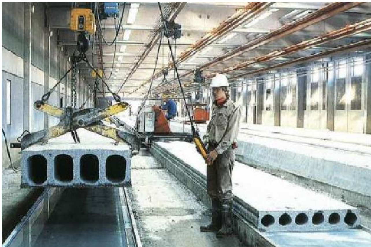
Figur 8. Forspændte huldæk skæres i længde og løftes fra spænddækket.
