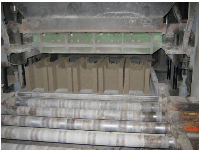
Figur 3. Produktion af udstøbningsblokke
