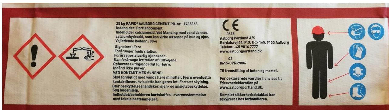
Figur 3. CE-mærket fotograferet på en sæk cement. Brugeren af et CE-mærket produkt skal kunne se CE-mærket på produktet, på en følgeseddel eller som her på emballagen. Cement var den første byggevare i Danmark, som blev CE-mærket.
