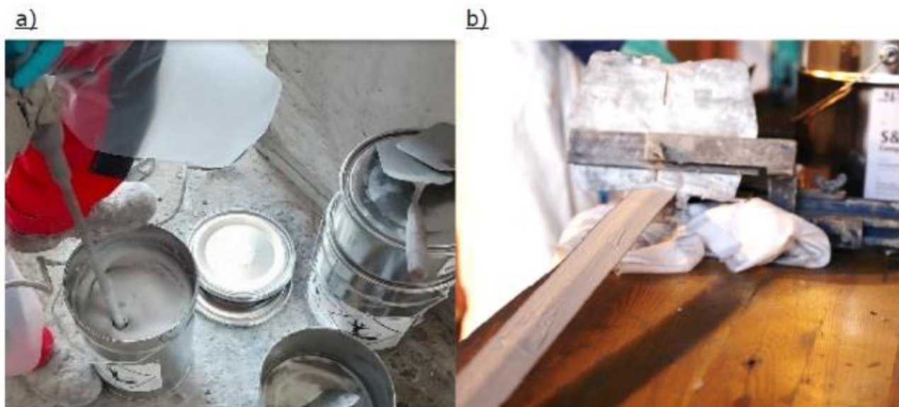
Figur 8 a) Opblanding af 2-komponent montagelim, og b) påføring på kulfiberlaminat.
