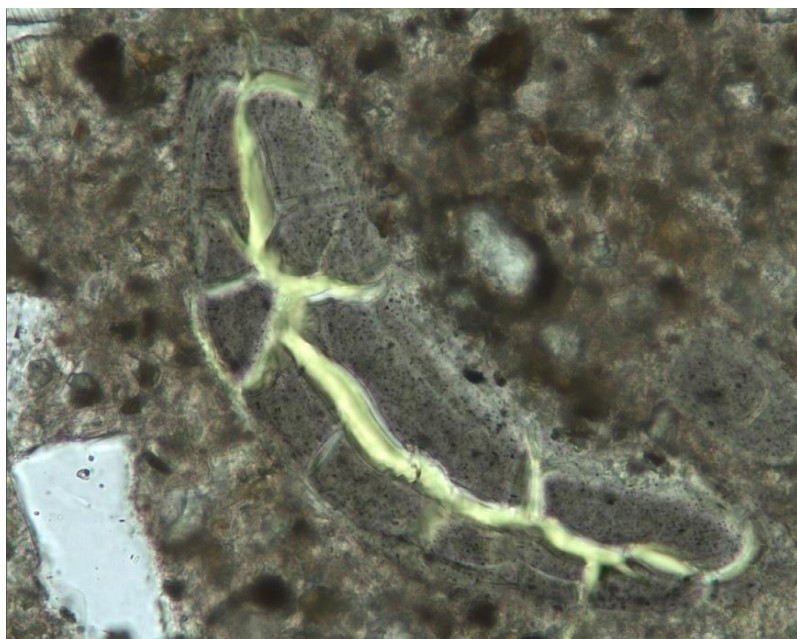
Figur 4. Mikrosilica kan have tendens til at klumpe, og det kan kræve en omhyggelig og langvarig blanding af betonen for at få splittet klumperne ud. Billedet viser en mikrosilicaklump i hærnet beton
