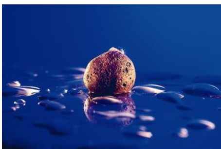
Figur 6. Letklinker 10-20 coated er kapillarbrydende.
