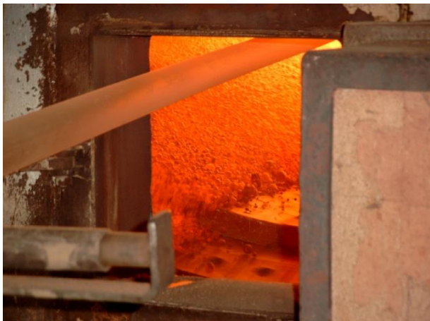
Figur 2. Brænding af ler til letklinker
