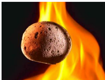
Figur 7. Letklinker brænder ikke.
