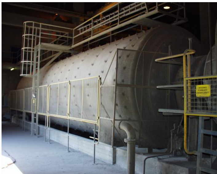
Figur 6. Aalborg Portlands kuglemølle til fremstilling af cement
