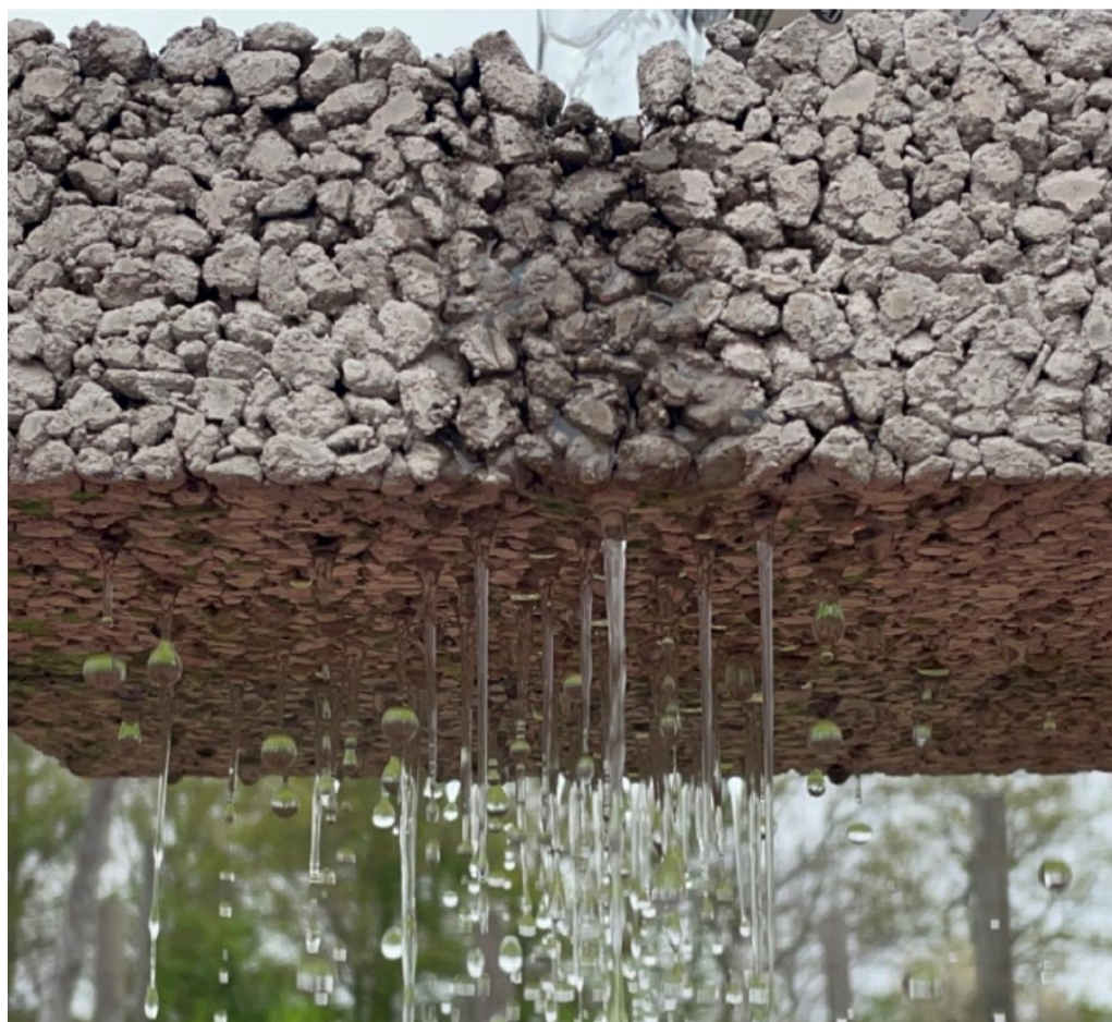
Figur 1 Permeabelt betonprøveemne, hvor der løber vand igennem en cirka 80 mm tyk prøve. Foto: Teknologisk Institut.
