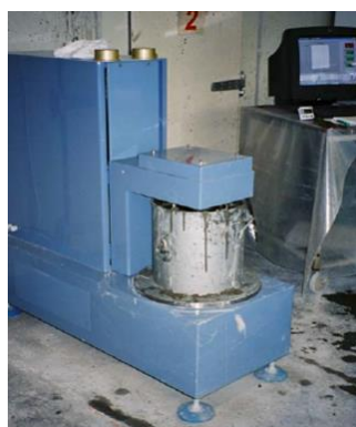
Figur 7. BML-viscometer. Eksempel på en cylinder-cylinder rheometer [3]
