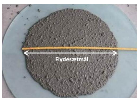
Figur 3. SCC og flydesætmålsklasser i henhold til EN 206
