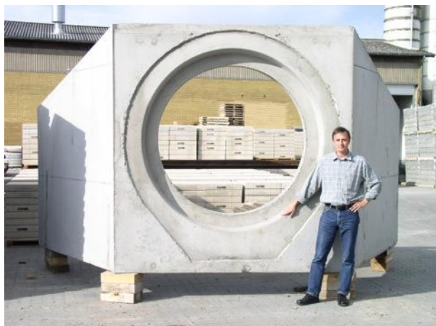
Figur 6. Ø 1600 mm udløbsbygværk, på lagerplads ved betonvarefabrik
