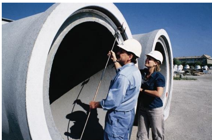
Figur 15. Manuel opmåling af samlingsmål på Ø 1600 mm rør
