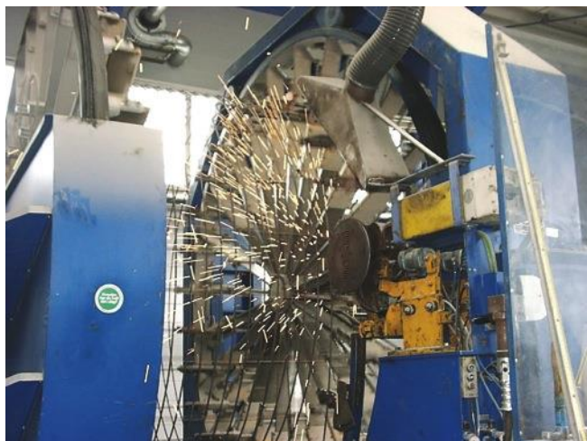
Figur 12. Rørformet armeringsnet fremstilles automatisk i armeringsmaskine
