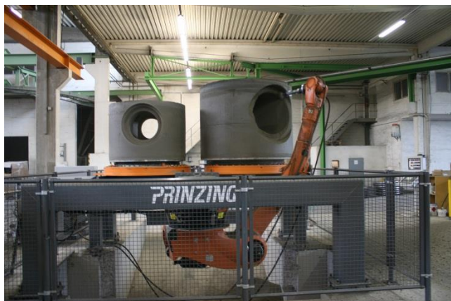
Figur 11. Fræserobot, en delproces i drejebørndsfremstillingen
