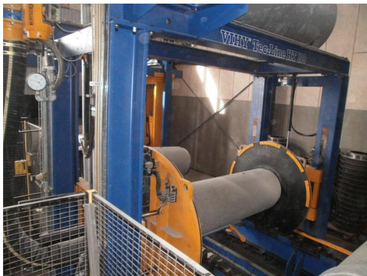
Figur 14. Automatisk tæthedskontrol i produktion. I testlinjen indgår også automatisk aftagning af stålbundringe, afgratning, opmåling og stempling
