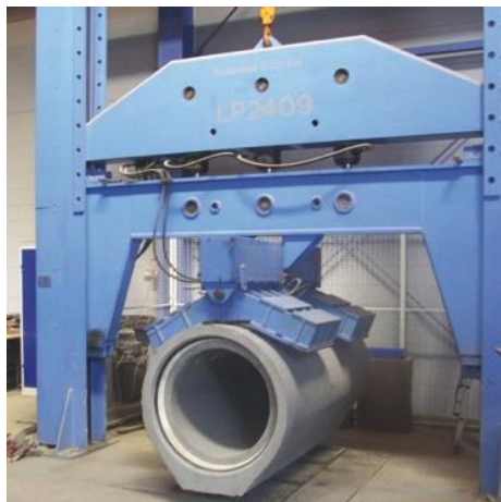
Figur 13. Styrkekontrol af Ø 700 rør med fod. Foto er fra før indførelsen af de europæiske standarder. I dag anvendes linjelast (topbelastningsbjælke) fremfor V-last
