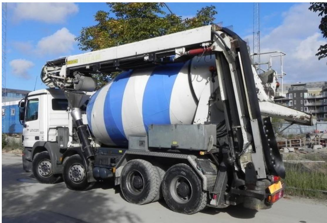
Figur 4. Båndbil: Transportbåndet er foldet sammen under kørsel
