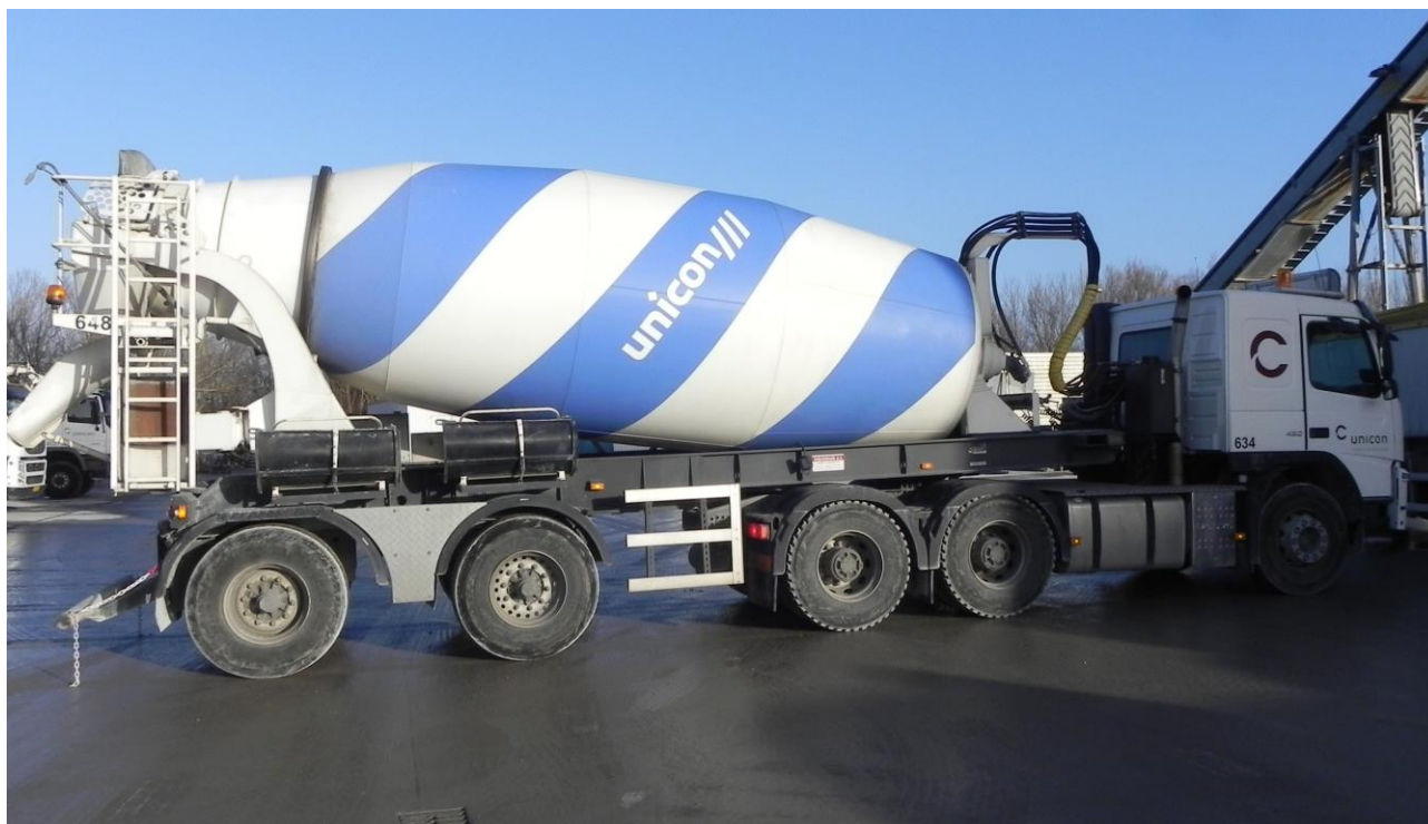
Figur 3. Denne 5-akslede sættevogn kan indeholde 11 m 3 beton
