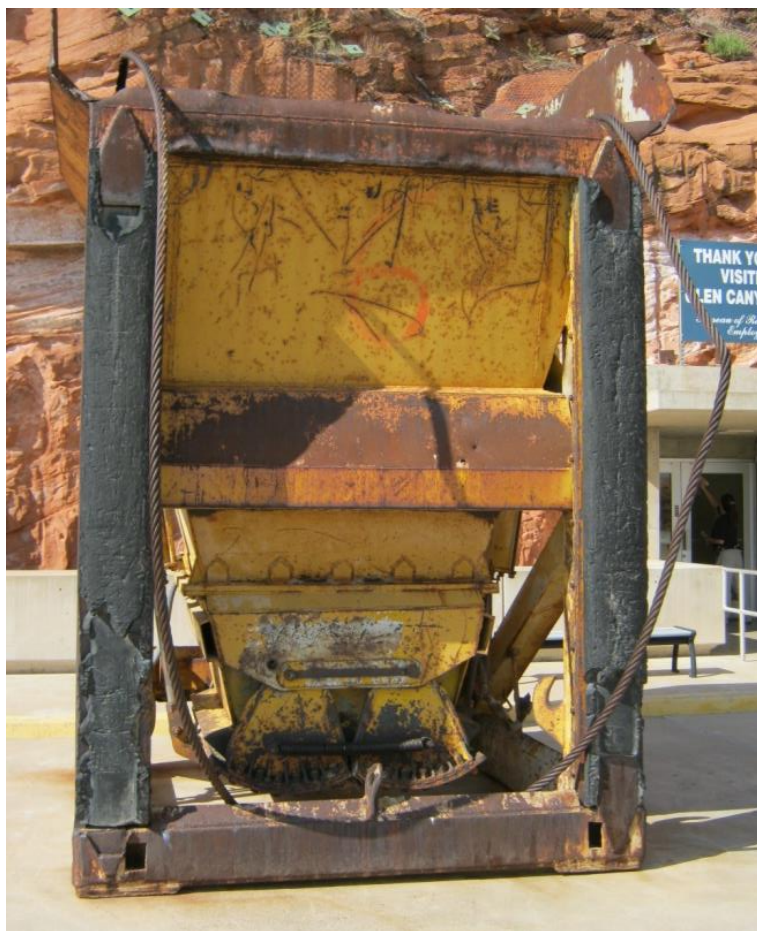
Figur 9. Denne kranspand kan indeholde 22 tons beton og den blev fyldt og tømt 400.000 gange, før Glen Canyon Dam over Coloradofloden i Arizona var fuldført
