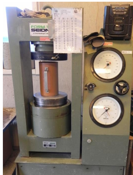
Figur 4. I et almindeligt betonlaboratorium kan måles konsistens, luftindhold og styrker (på en trykpresse – se billedet til højre). Se også kapitel 15.1
