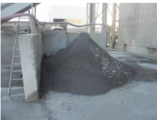
Figur 6. Vaskevand fra biler, blandemaskiner og udvasket overskudsbeton kan genanvendes. Overskudsbeton deles i tromlen øverst til venstre i tilslag og vand med finmateriale. Enten skal finmaterialet holdes opslemmet eller bundfældes. Til højre ses et opslemningsklar. Det genvundne tilslag (nederst til venstre) kan genanvendes til beton, men bruges ofte til sekundære formål
