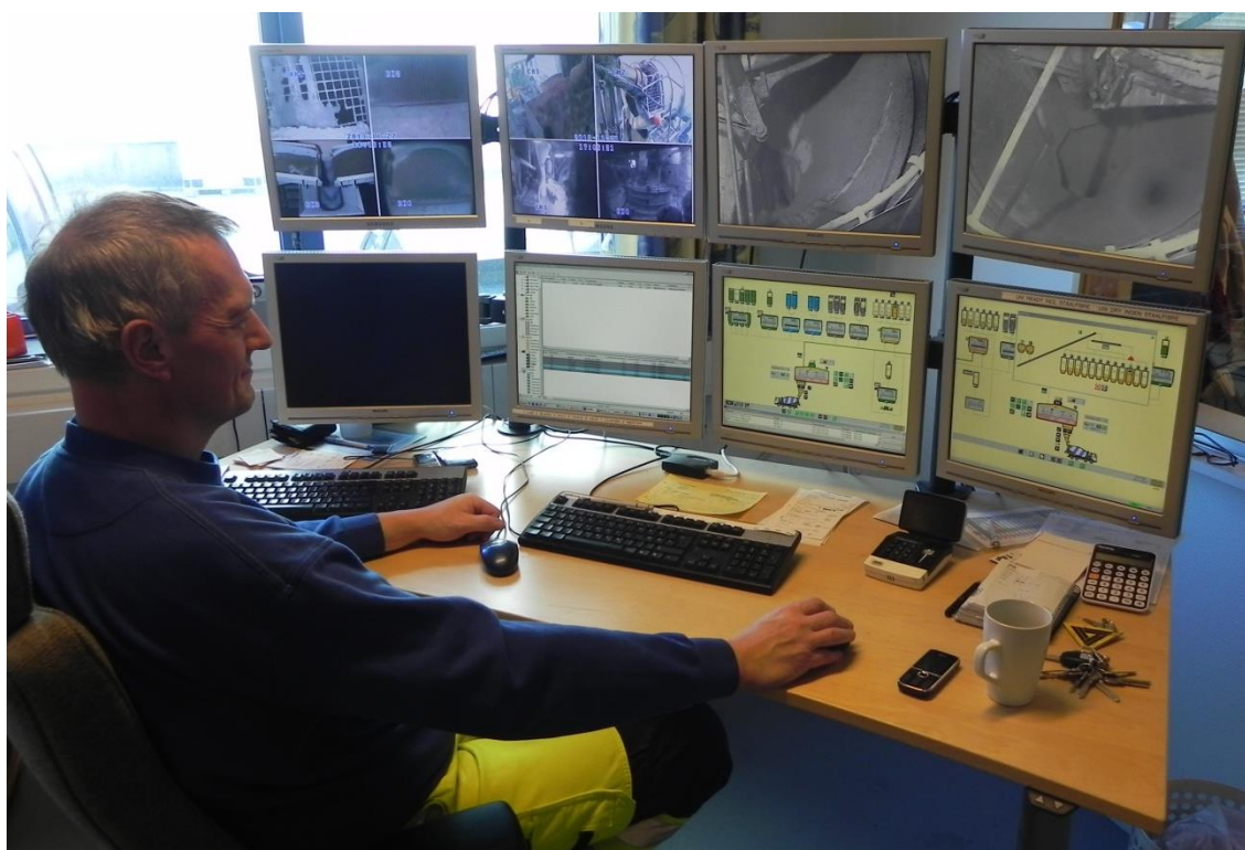
Figur 8. Blandemesteren finder den korrekte recept frem og styrer doseringen på skærmene nederst til højre. På de to øverste skærme til venstre kan han følge doserings- og blandeprocessen, og på skærmene øverst til højre kan han følge læsningen af bilerne
