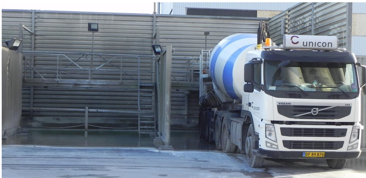
Figur 15. Det er vigtigt, at betonkanonen rengøres efter brug. Det tager typisk ½ time at rengøre bilen ordentligt. Glemmes det, er det i gang med lufthammer inde til tromlen, hvilket ikke er et rart stykke arbejde. Vaskevandet kan genbruges – se figur 6
