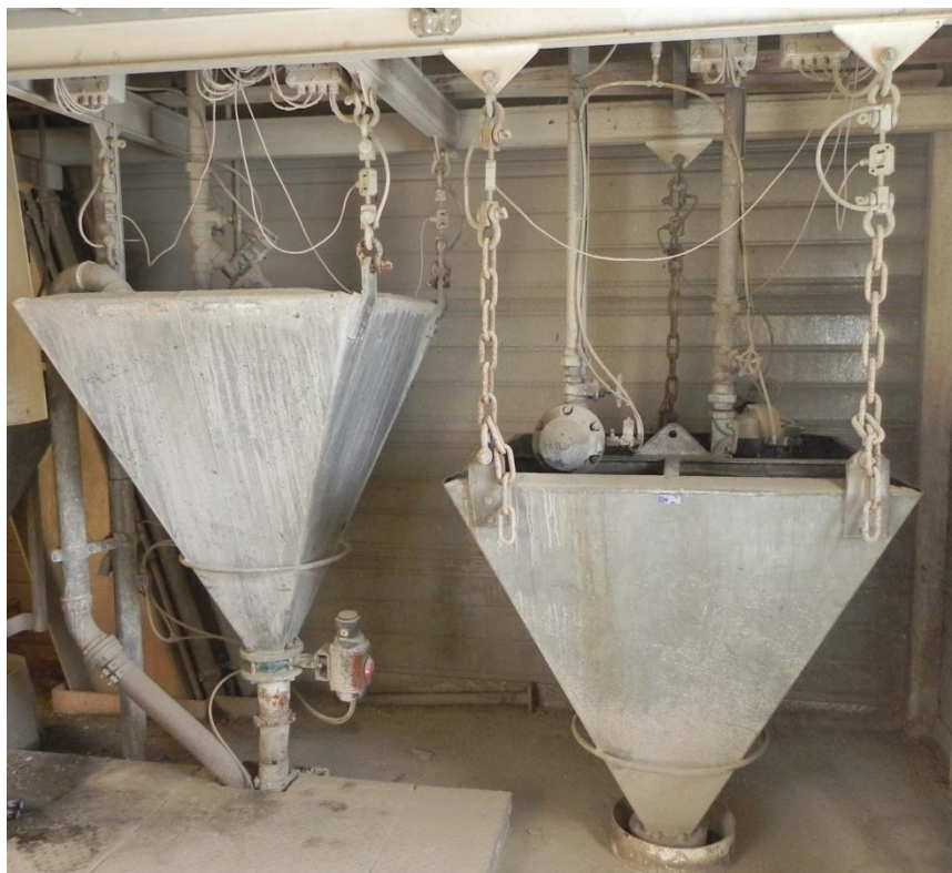
Figur 7. De to omvendte pyramide-formede beholdere er vandvægte ophængt i vejeceller. Vandvægten til højre er til drikkevand – vandvægten til venstre er til genbrugsvand
