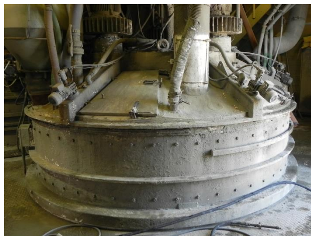
Figur 13. Princip i tvangsblender og blanderen på fabrikken (med tre motorer)
