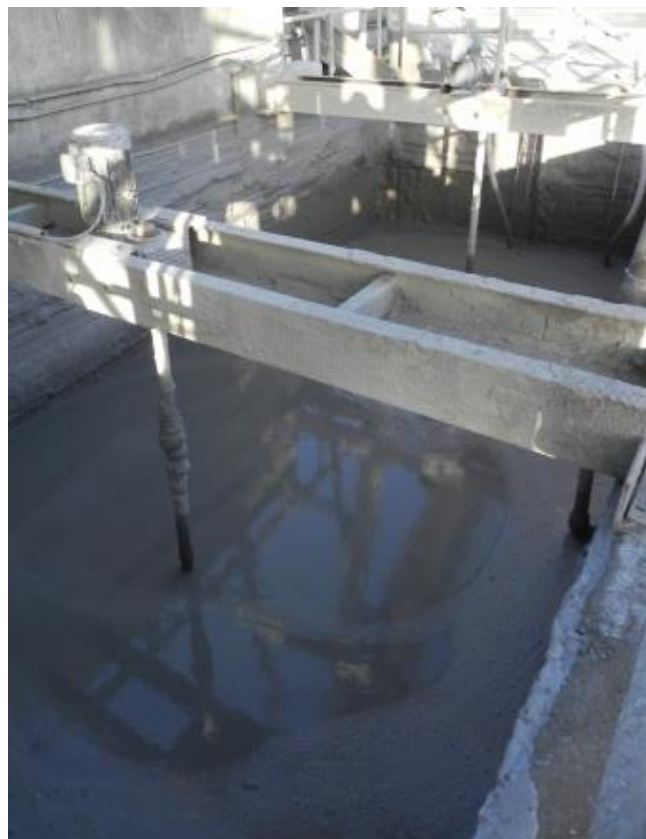
Figur 6. Vaskevand fra biler, blandemaskiner og udvasket overskudsbeton kan genanvendes. Overskudsbeton deles i tromlen øverst til venstre i tilslag og vand med finmateriale. Enten skal finmaterialet holdes opslemmet eller bundfældes. Til højre ses et opslemningsklar. Det genvundne tilslag (nederst til venstre) kan genanvendes til beton, men bruges ofte til sekundære formål
