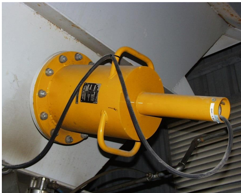
Figur 11. Neutronmåler til måling af fugt direkte i tilslagssiloen umiddelbart over doserings-spjældet
