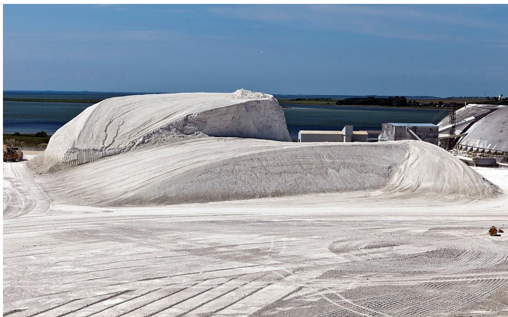
Figur 1. Kalkfiller anvendes som tilsætning i beton. Billedet er fra Dankalk i Aggersund
