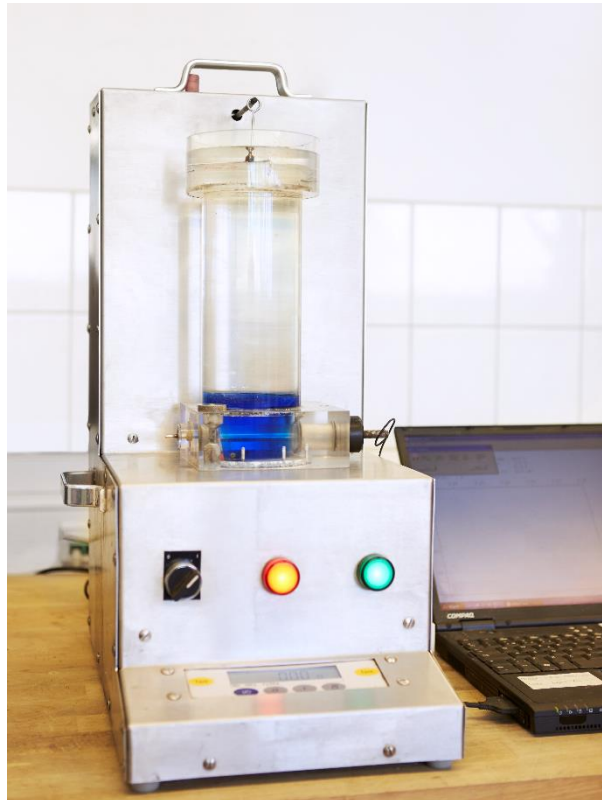
Figur 5. Luftporenes størrelsesfordeling i frisk beton kan måles med en Air Void Analyser (AVA). En frisk betonprøve blandes ud i den blå væske, hvorefter boblerne stiger langsomt op gennem den lyse væske (med høj viskositet) i cylinderen og
