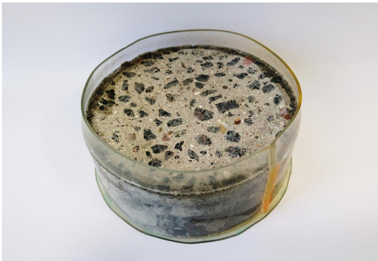
Figur 8. 50 mm skive af betoncylinder forsynet med gummimanchet og klar til funktionsprøvning i henhold til SS 137244 eller CEN/TS 12390-9.
