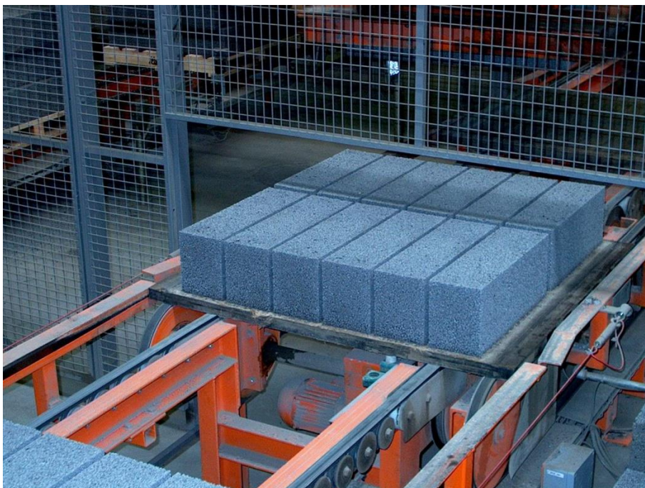
Figur 2. Produktion af letklinkerblokke i fuldautomatiske anlæg
