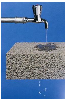
Figur 9. Letklinkerblokke suger ikke vand
