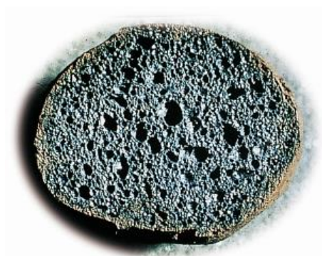
Figur 7. Gennemskåret letklynke – diameter ca. 20 mm
