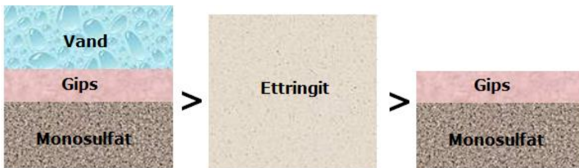
Figur 3. Reaktanterne (vand, gips og monosulfat) har et større volumen end reaktionsproduktet (ettringit), og ettringitdannelsen er derfor ikke ekspansiv, men faststofvolumenet stiger, og da vandet altid tilføres udefra, sker der en ekspansion, idet V_{\text{ettringit}} > V_{\text{gips}} + V_{\text{monosulfat}} .
