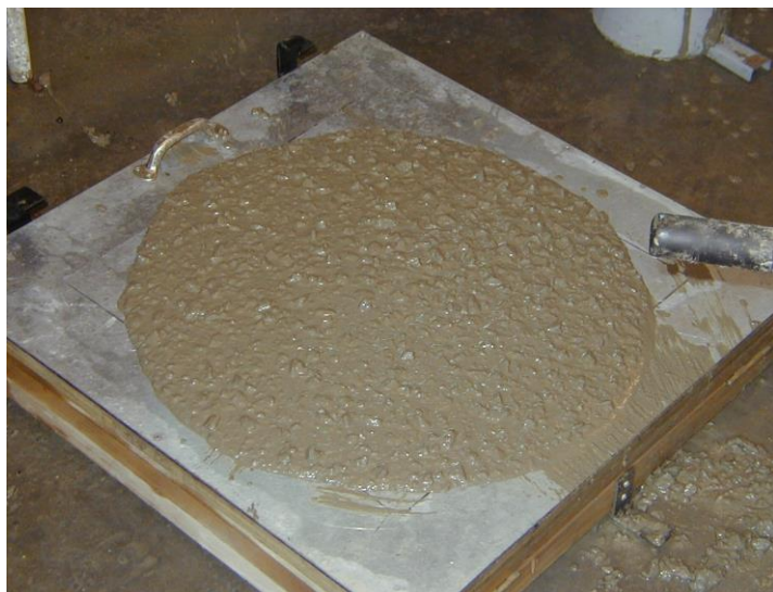
Figur 8. Ved brug af SCC-beton kan sætmålet ikke anvendes. Her anvendes – som på billedet – ofte flydesætmålet. Flydesætmålet på billedet er omkring 570 mm, da pladen på fotoet er et kvadrat med en sidelængde på 700 mm. Tilstræbt flydemål til fx gulve er ofte 570 \pm 50 mm, mens der til fx vægge ofte tilstræbes en blødere beton på 620 \pm 50 mm.
