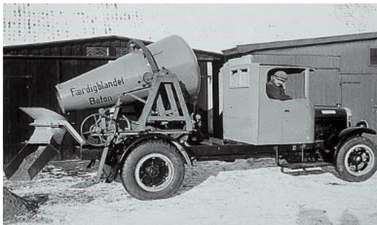
Figur 4. Første rotérbil fra 1927. Rotérstellet monteret på et lastbilchassis. Max. volumen 1,25 m 3 beton.
