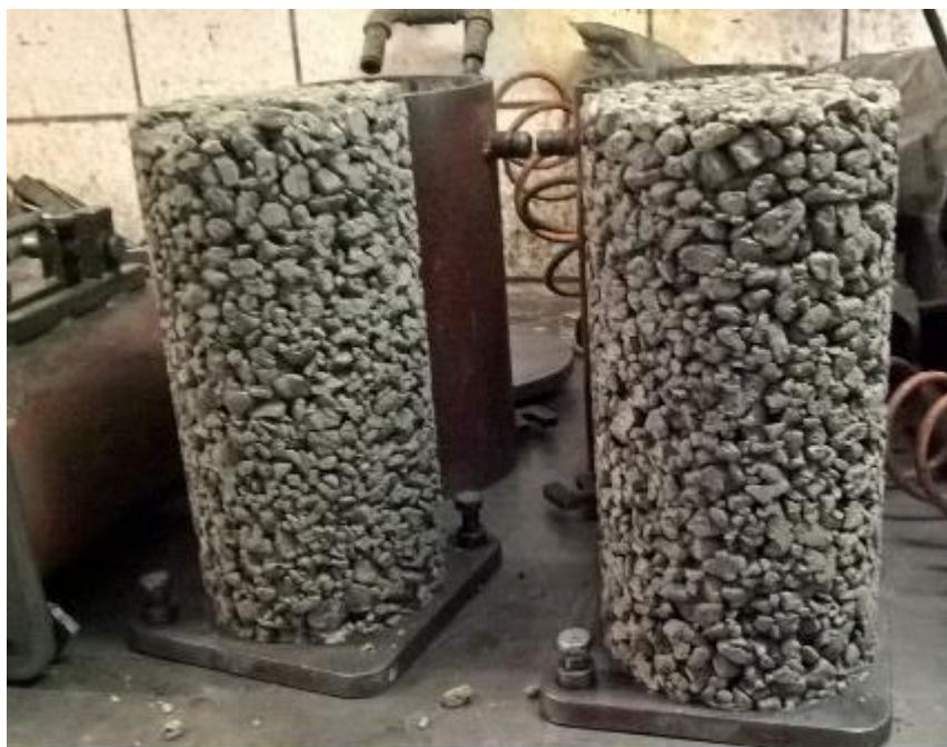
Figur 14. Drænbeton udstøbt i cylindre til måling af trykstyrke.
