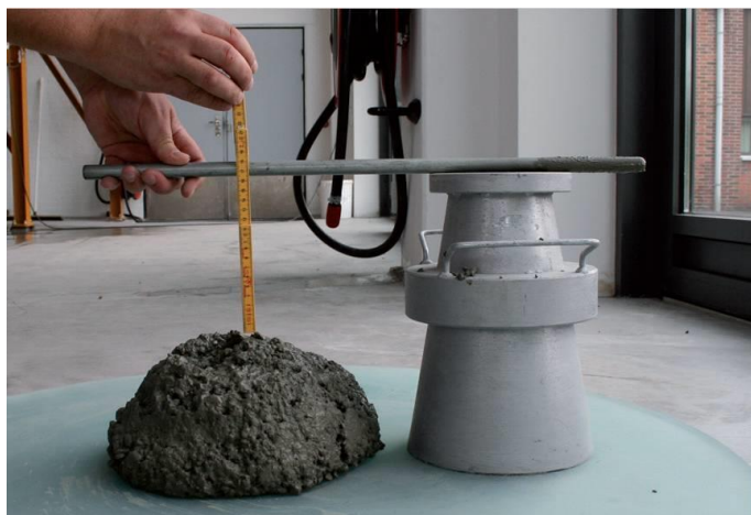
Figur 7. Sætmålsbeton. Betonen på figuren har et sætmål på omkring 160 mm (keglehøjden er 300 mm).
