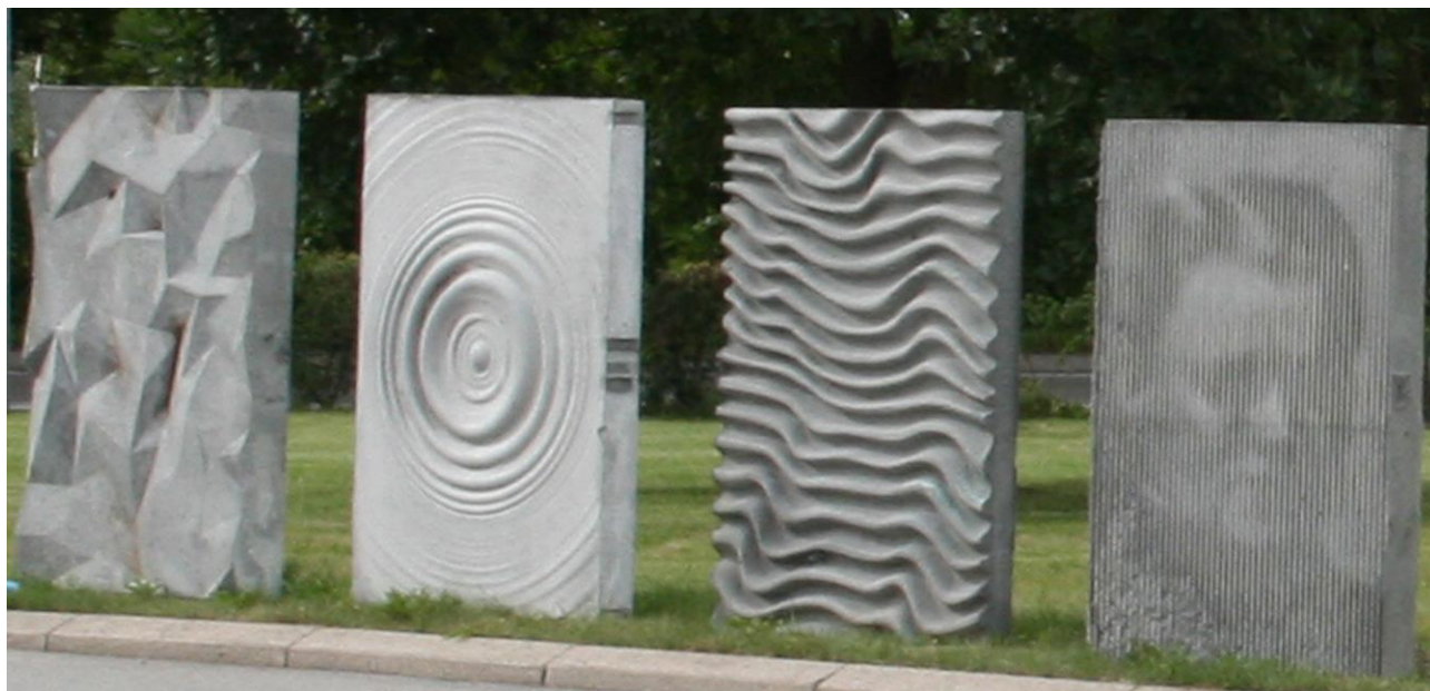
Figur 37. Teknologisk Institut har udført en række demonstrationsforsøg med relieffer skabt via digital fabrikation. Mulighederne er som det ses store, men effekterne skal anvendes med betydelig arkitektonisk forsigtighed.
