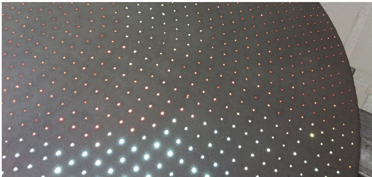
Figur 38. Optiske lysledere i beton giver mulighed for at transportere lys fra betonens bagside frem til overfladen.
