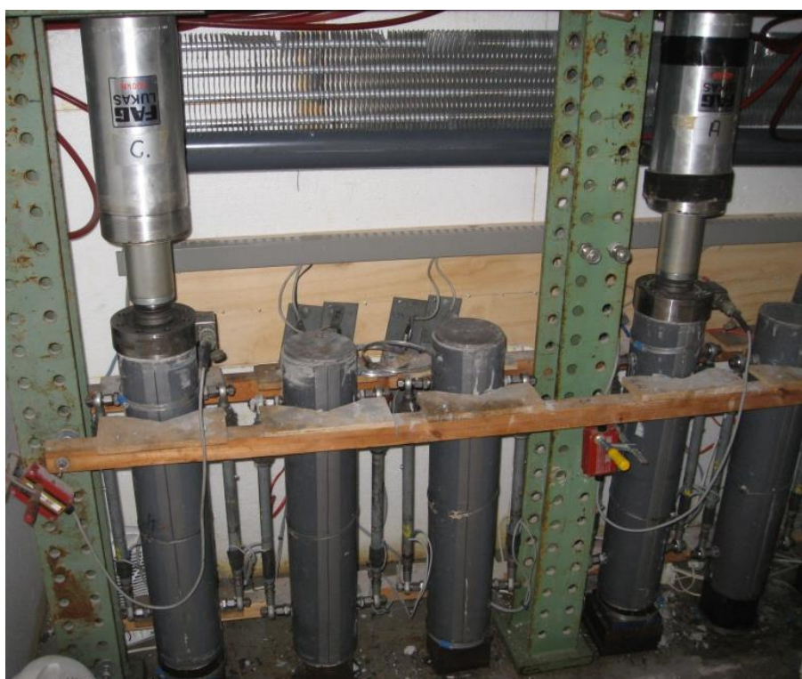
Figur 5. Opstilling til måling af autogent svind og krybning efter TI-B 102. Der måles autogent svind på tre emner og krybning på tre emner. Der måles fra betonens afbindingstidspunkt. Betonen udstøbes i plastrør, som sikrer, at der ikke kan udveksles fugt med omgivelserne.
