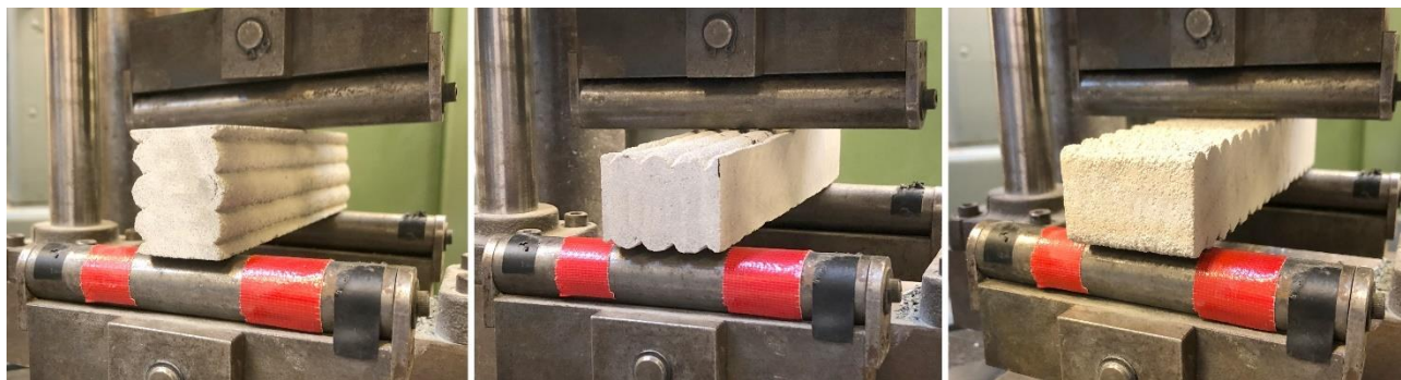
Figur 6: Mekanisk bøjetrækprøvning af 3D-printede betonemner. Denne type forsøg udføres typisk i 3 forskellige retninger for at kvantificere indflydelsen af den lagvise opbygning og printretning. Emnet udsættes for tre-punktsbøjning, og brudlasten registreres og omregnes til en trækstyrke.
