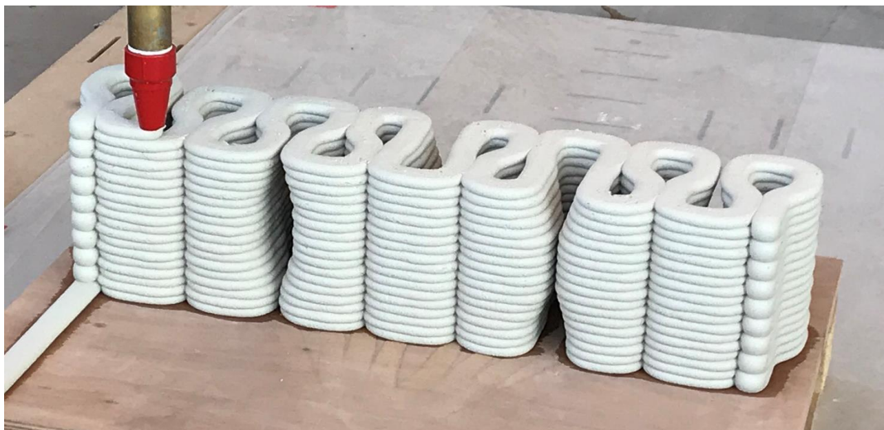
Figur 1: 3D-betonprint ekstruderes lag-på-lag i en digital fabrikationsproces.
