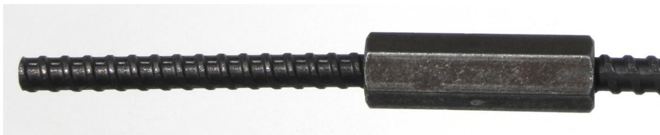
Figur 5. 15 mm forspændings-stang med kæmpegevind. Gevindet er over hele stangens længde, der derfor let kan afskæres i ønsket længde. På grund af den store styrke og det meget grove gevind er møtrikker og koblinger (som på billedet) relativt lange. Sådanne stænger bruges også til sammenspænding af forme som spændestave – ofte kaldet klamsjern – se afsnit 9.2 Form.
