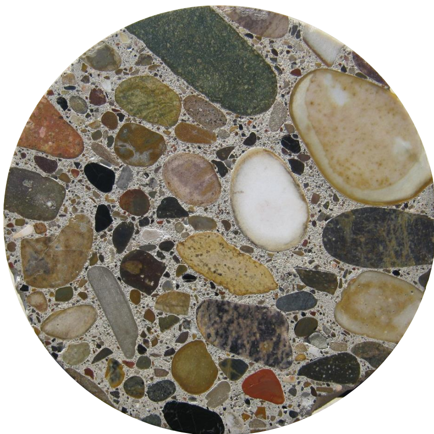
Figur 2. Planslib af beton. Beton er tilslag limet sammen med en lim (cementpasta) bestående af cement (binder) og vand (hærder). Limen kan forbedres med fx tilsætninger, tilsætningsstoffer og luft. Krav til beton afspejler denne opbygning. Billedet er fra en borekerne udtaget af Glen Canyon Dam, Arizona, fuldført 1963.
