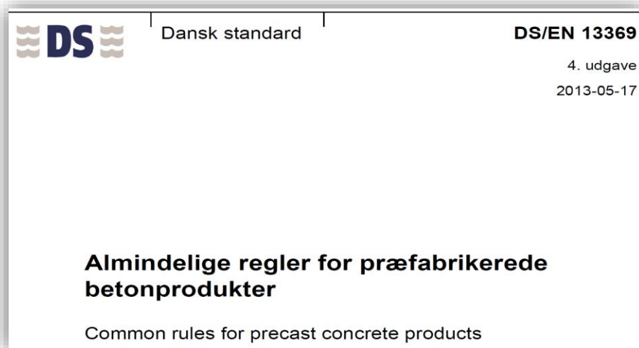
Figur 9. Betonelementer skal produceres i henhold til en række harmoniserede produktstandards. En fællesdel, der gælder for alle betonelementer er samlet i DS/EN 13369, der således skal opfyldes sammen med den enkelte harmoniserede standard.
