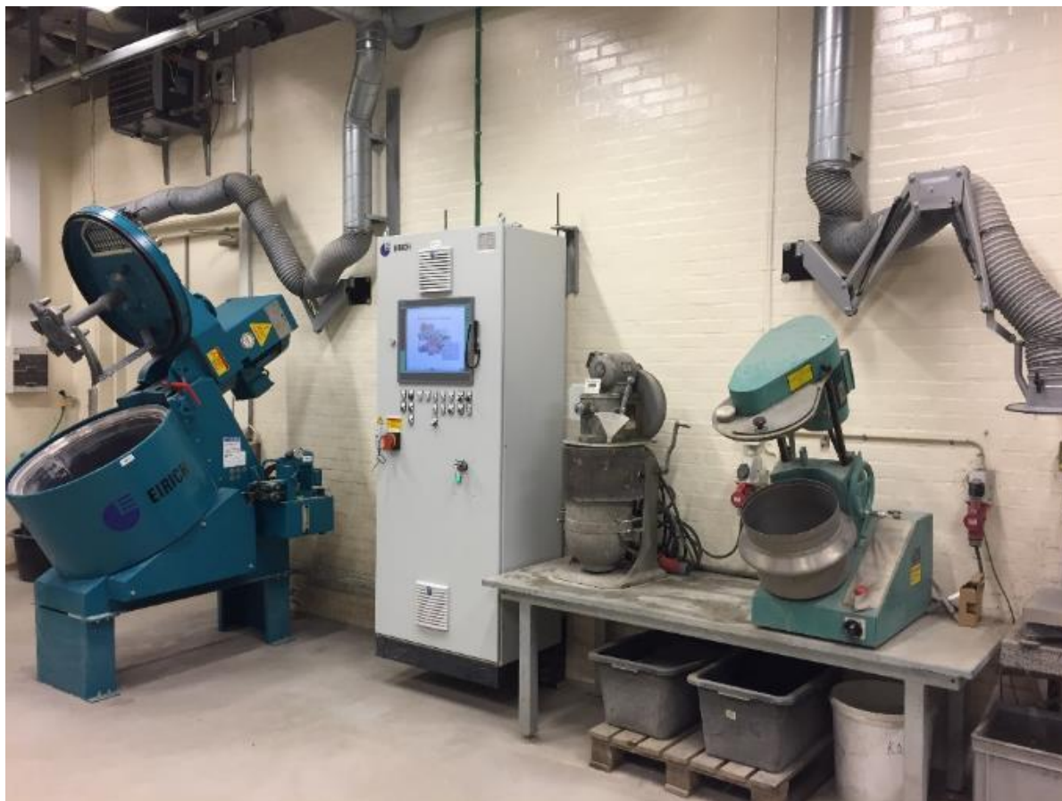
Figur 1. Blandere i betonlaboratoriet – Forskellige blandere til blanding af frisk beton. Foto: Teknologisk Institut.
