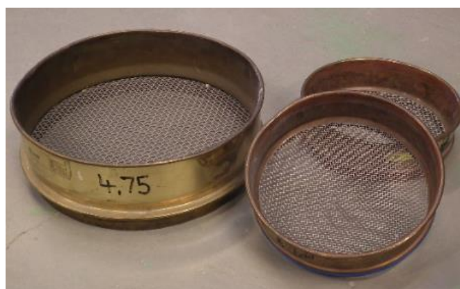
Figur 12. Eksempler på udstyr til prøvning af tilslag. Til venstre - sigtesøjle, til højre - sigter. Foto: Teknologisk Institut.
