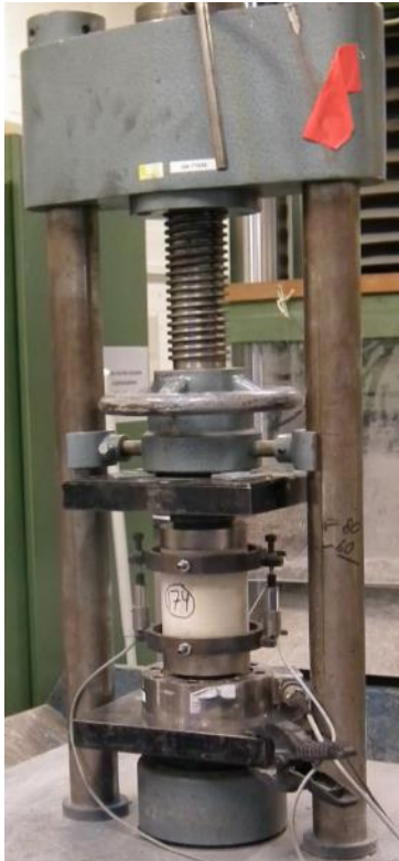
Figur 16. Trykprøvningsmaskiner. Til venstre – trykpresse, max kapacitet 200 kN. Midt – trykpresse max kapacitet 3000 kN Til højre – trykpresse, max kapacitet 4900 kN. Foto: Teknologisk Institut.
