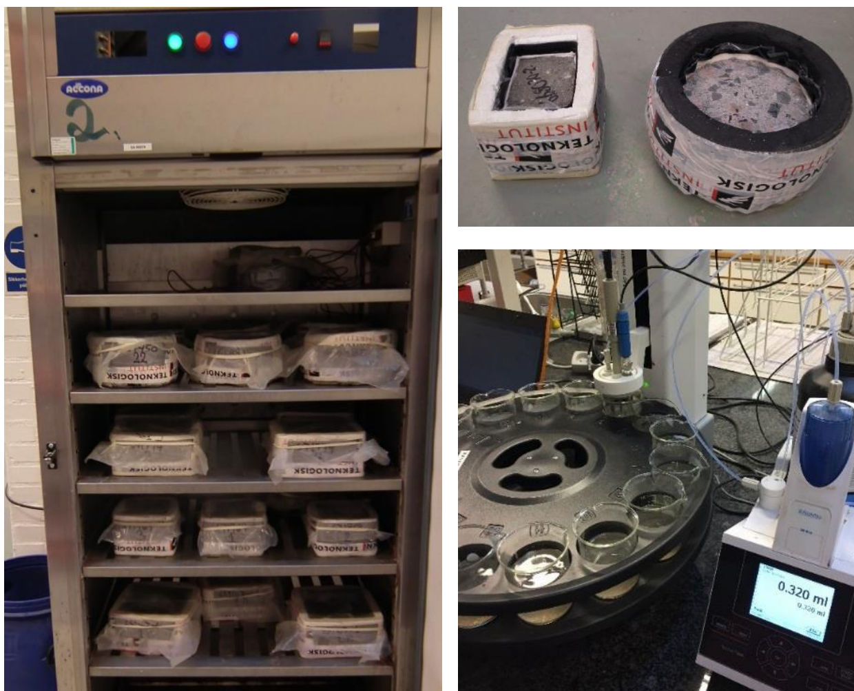
Figur 17. Eksempler på udstyr til holdbarhedsprøvning. Til venstre - Prøvelegemer til frostprøvning i frostskaab, øverst til højre - eksempler på prøver til frostprøvning. Nederst til højre -udstyr til potentiometrisk titrering. Foto: Teknologisk Institut.
