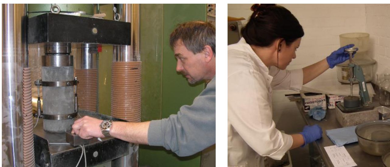
Figur 3. Standardiseret prøvning – Til venstre: Prøvning af betons E-modul, til højre: Prøvning af cements afbindingstid. Foto: Teknologisk Institut
