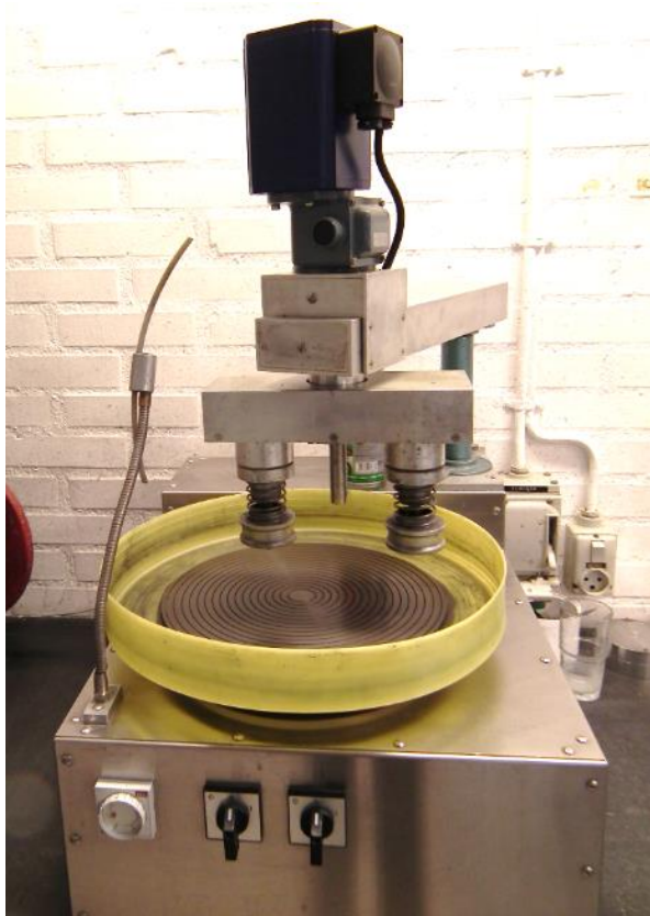
Figur 18. Til venstre – slibeudstyr til præparation af prøver til luftporeanalyse. Til højre – automatiseret udstyr til luftporeanalyse. Foto: Teknologisk Institut.
