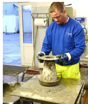
Figur 5. Til venstre og midt – måling af luftindhold i frisk beton med pressurmeter. Til højre – måling af flydesætmål (selvkompakterende beton). Foto: Unicon.
