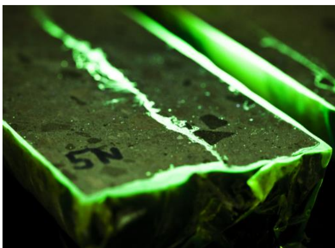
Figur 11. Planslib: Gennemskåret betonkerne imprægneret med fluorescerende epoxy. Revner træder tydeligt frem når præparatet eksponeres i UV. Foto: Teknologisk Institut.
