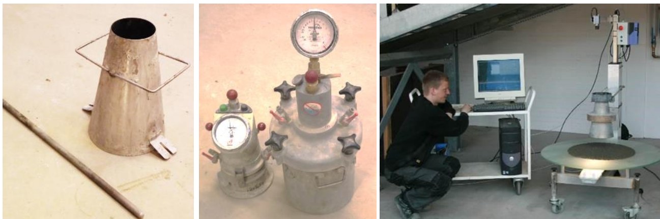
Figur 14. Til venstre - sætmålskegle. I midten - pressurmeter til bestemmelse af luftindhold i hhv. mørtel (ca. 1 l) og beton (ca. 8 l). Til højre udstyr til måling af flydesætmål (for SCC). Foto: Teknologisk Institut.
