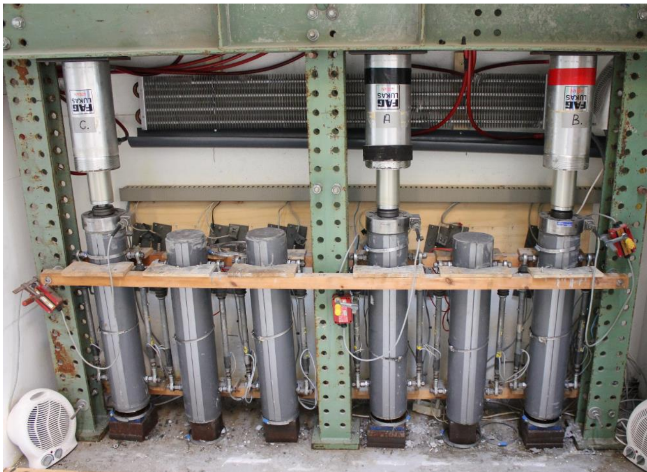
Figur 9. Udstyr til bestemmelse af betons krybning og svind til brug for blandt andet hærdeberegninger. Foto: Teknologisk Institut
