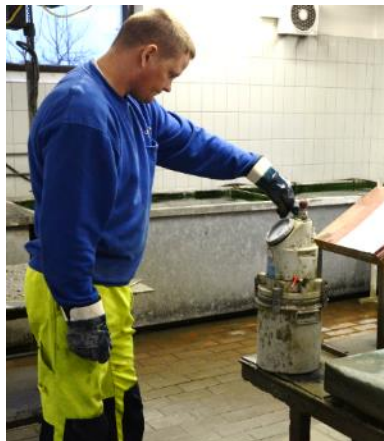
Figur 5. Til venstre og midt – måling af luftindhold i frisk beton med pressurmeter. Til højre – måling af flydesætmål (selvkompakterende beton). Foto: Unicon.
