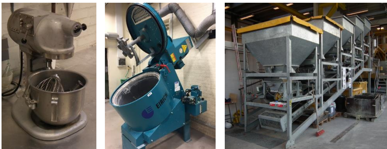
Figur 13. Eksempel på forskellige typer blandemaskiner. Til venstre en standardiseret såkaldt 5 l (med reference til karrets totalvolumen) blander med en max. kapacitet ca. 2 l. I midten – Betonblander – max kapacitet ca. 60 l. Til højre – betonblander, der bortset fra en mindre kapacitet svarer til en produktionsblander – max kapacitet ca. 250 l. Foto: Teknologisk Institut.
