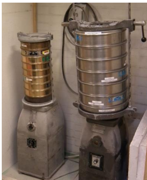
Figur 12. Eksempler på udstyr til prøvning af tilslag. Til venstre - sigtesøjle, til højre - sigter. Foto: Teknologisk Institut.
