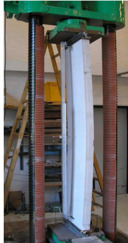
Figur 16. Trykprøvningsmaskiner. Til venstre – trykpresse, max kapacitet 200 kN. Midt – trykpresse max kapacitet 3000 kN Til højre – trykpresse, max kapacitet 4900 kN. Foto: Teknologisk Institut.
