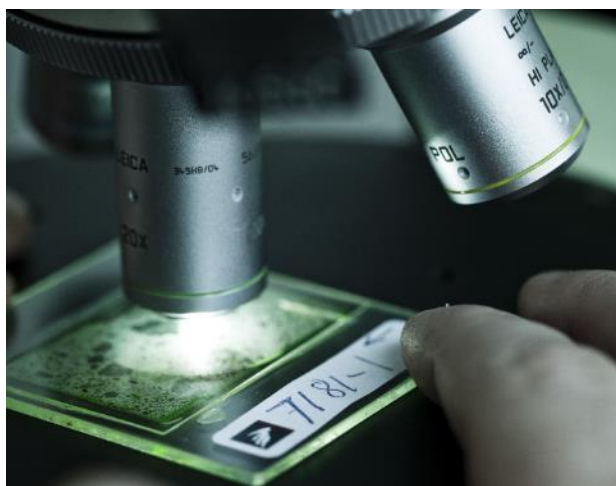
Figur 10. Tyndslib til petrografisk analyse – til højre ses et tyndslib i lysmikroskop. Foto: Teknologisk Institut.
