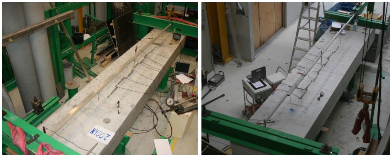
Figur 4. Special prøvning (ikke standardiseret) – Bøjningspåvirkning af pladeudsnit med kombineret stålfiber og traditionel armering. Foto: Teknologisk Institut
