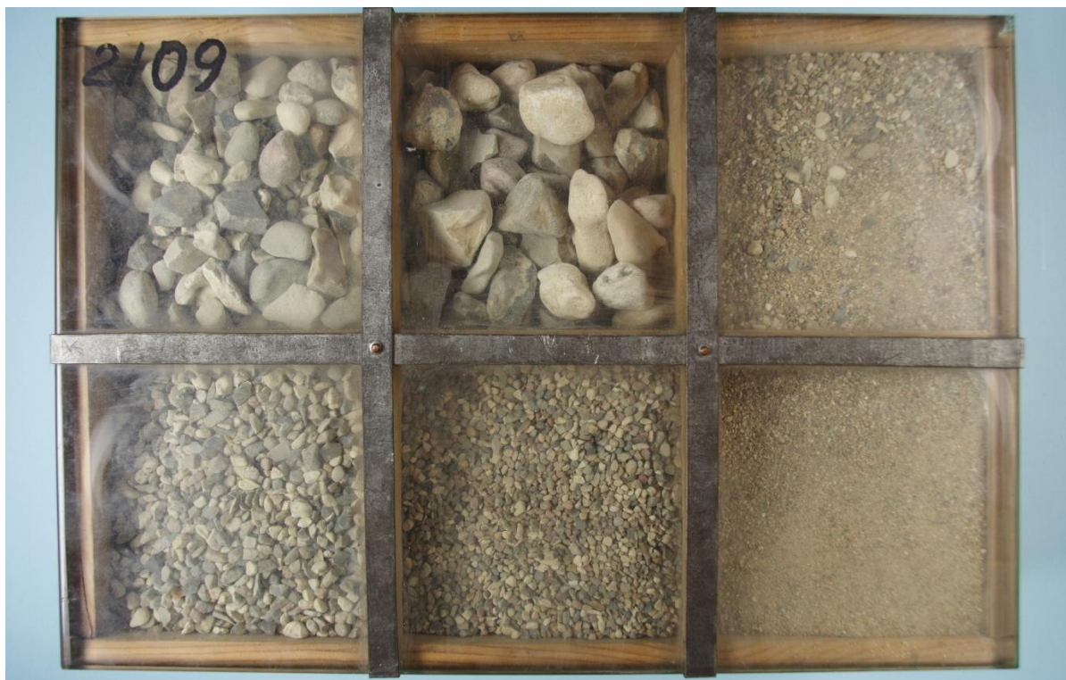
Foto 16. Billedet viser bakkegrus fra Hedehusene, som Suenson undersøgte i 1910 for at finde ud af, om grusets naturlige kornkurve var passende for dets anvendelse til beton, og om man ved at ændre på kornkurven kunne øge betonens styrke. En grusprøves kornkurve fortæller, hvorvidt gruset består af sorteret materiale med ensartet kornstørrelse, eller om der i stedet er en jævn fordeling af partikler med forskellig størrelse, hvilket muliggør en tættere pakning. God beton afhænger ikke kun af cementen, men også af pakningen af tilslaget. Foto: Teknologihistorie DTU.
