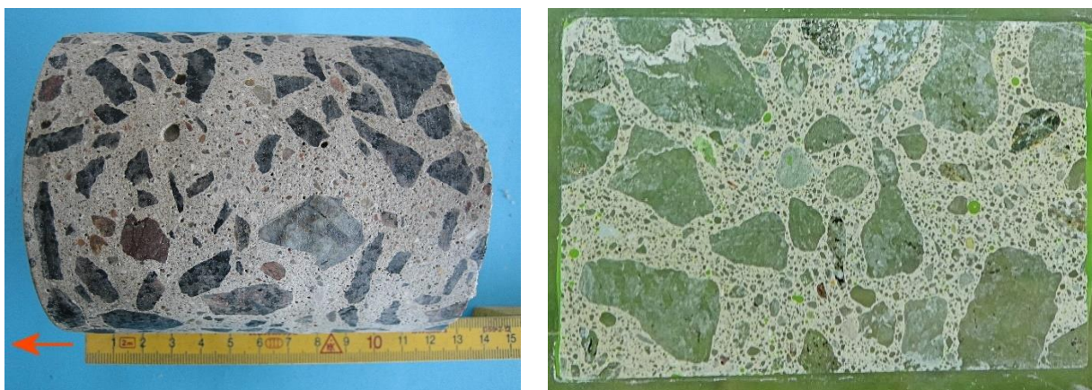
Figur 5: Tv. ses en borekerne i god kvalitet, med boresiden placeret tv. og med skarpt aftegnede snit gennem tilslagspartikler. Th. ses et helt tyndslib, ca. 30 mm x 45 mm.
