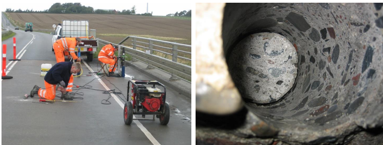
Figur 3: Tv. ses udtagning af boreprøver på Grøn Beton forsøgsbro. Th. ses et foto af et borehul, som er vigtig dokumentation i forhold til borekerner. For nye betontyper med særlige krav til lang levetid eller betoner med en grøn profil som anvendt i Grøn Beton projekterne indgår strukturanalyse som en vigtig metode til at følge betonerne i disse udviklingsprojekter fra de produceres til mange år efter.
