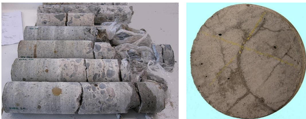
Figur 4: Tv. ses eksempel på borekerner lige efter udboring. Kernerne foreligger i flere dele, og det er vigtigt at samle "puslespillet" inden makroanalysen. På foto th. ses en kerneoverflade med revner og lidt kridtafmærkning. Revnerne ses som netrevner, mørkt aftegnede og med lidt fedtede udfældninger, hvilket kan være tegn på AKR.
